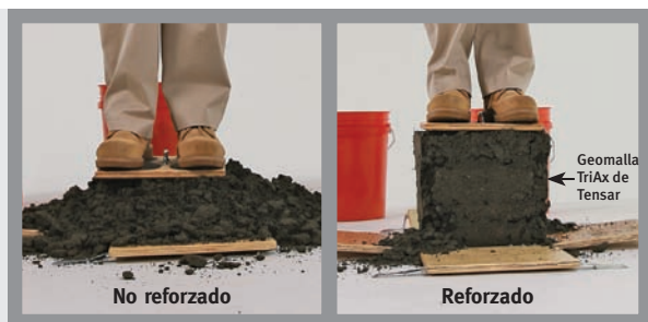
Figura 1 El confinamiento lateral del agregado reforzado con la geomalla TriAx de Tensar se ilustra a partir del ejemplo de la caja de rocas.
